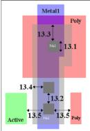
SCMOS Layout Rules - Capacitor Well (((solo para SCM3MLC)))
